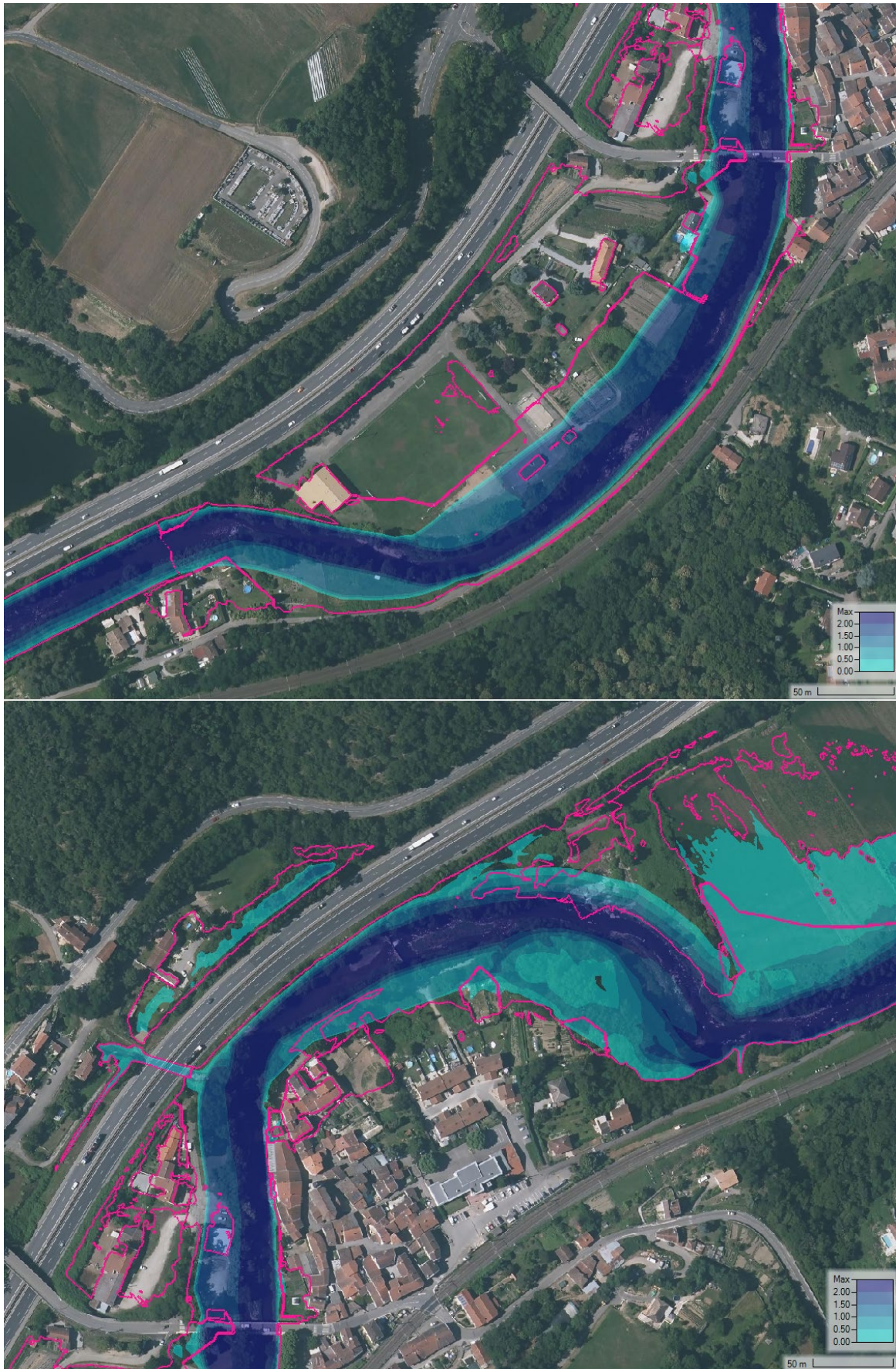
Figure 13 : Impact hydraulique du projet T = 30 ans
